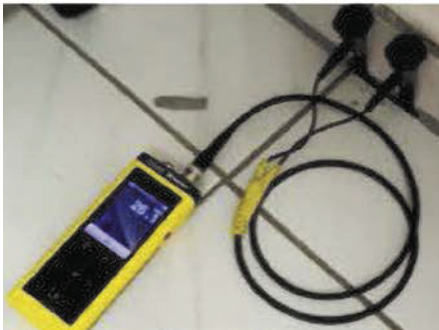
(3) Messverfahren: Mikrowellenmesstechnik, kapazitives Verfahren, Widerstandsverfahren
